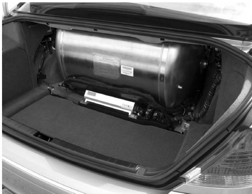
Бак для водорода в багажнике автомобиля.
