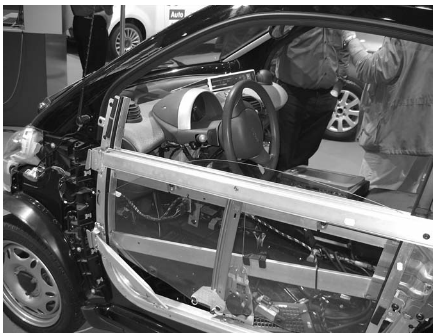
Макет автомобиля от компании NGK: размещена вся производимая продукция, причем в том положении и в том виде, в каком она «служит» в реальном транспортном средстве.
