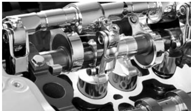
Система непрерывного изменения газораспределения и степени открытия впускных клапанов VVEL от Nissan.
