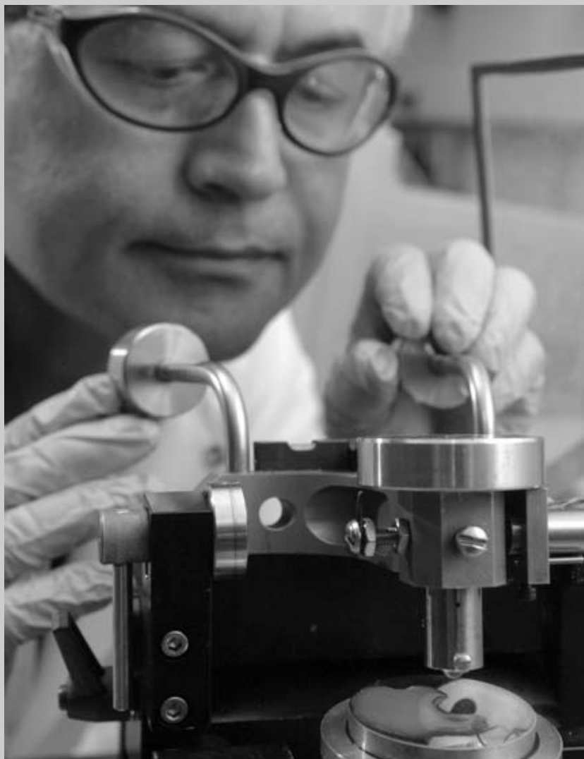
Али Эрдемир, ученый из Национальной лаборатории имени Аргона (США), проводит тест по замеру трения масла с добавлением наночастиц борной кислоты. Он уже на протяжении 20 лет изучает свойства этого вещества.
