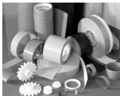
Фторопласт – замечательный полимер, из которого можно изготовить множество деталей с уникальными свойствами. Однако для работы в двигателе внутреннего сгорания гражданского автомобиля он не предназначен.
