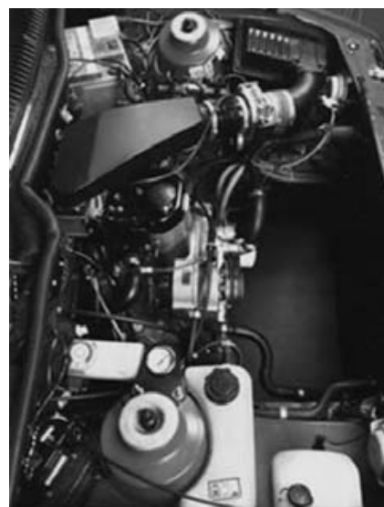
Под капотом Ford Sierra двигатель SYTEC занимает вдвое меньше места, чем ее «родной» мотор.
