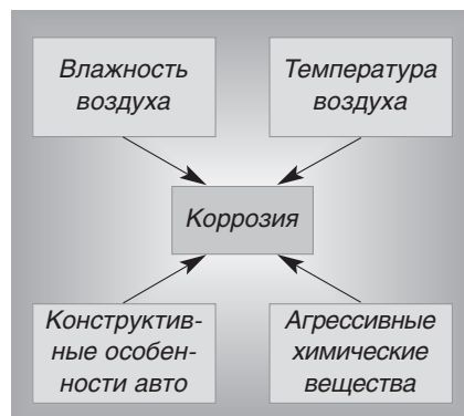
Основные факторы, вызывающие «болезни» металлических деталей автомобиля.
