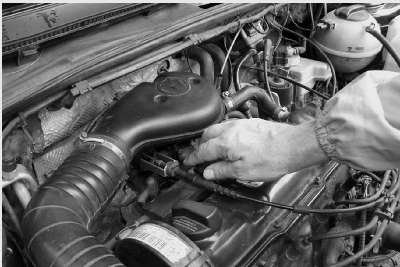
Предварительно в автомобиль была внесена условная «неисправность» регулятора холостого хода.
