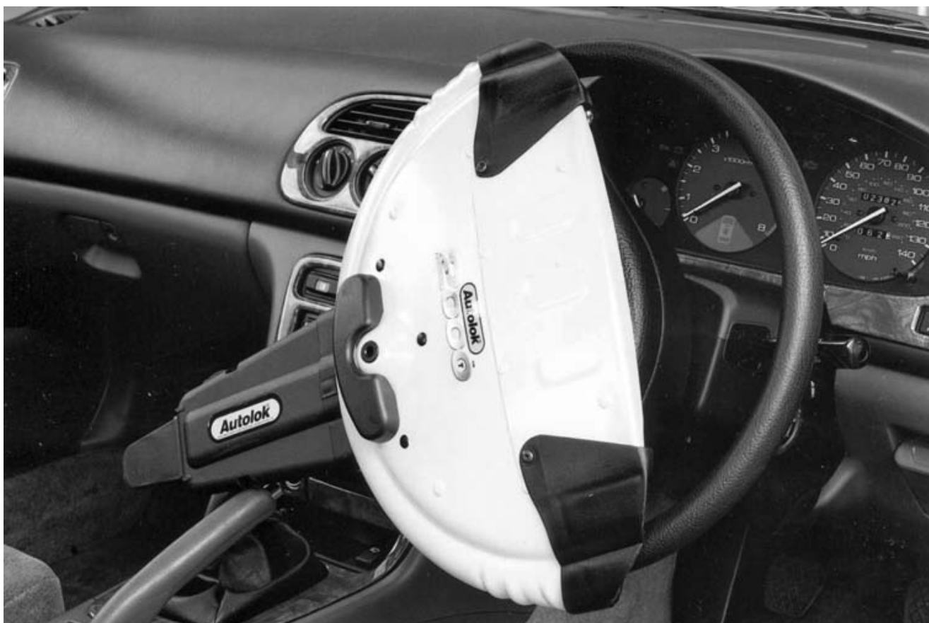
Иммобилайзер не дает рулевому колесу проворачиваться, делая управление невозможным.
