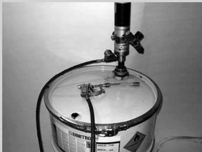
К емкости с антикором подключается специальный воздушный насос.
