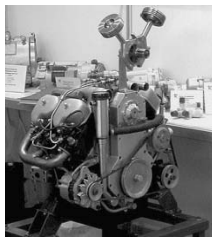
Вместо шатунов у двигателя Баландина – штоки, движущиеся возвратно-поступательно. Вместо коленвала – эксцентриковый вал.
