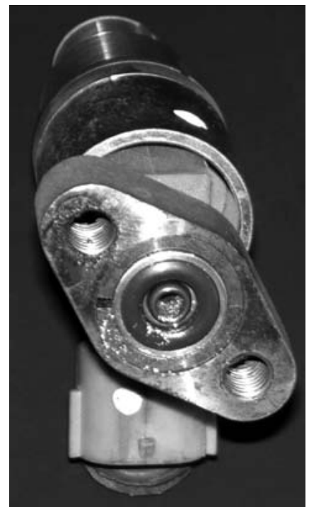
Фото 5. Следы износа ТНВД.
