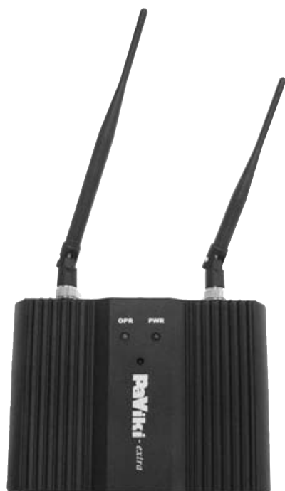
Эти устройства (джаммеры) изначально предназначались для глушения GSM-сигнала в заведениях, где нежелательно использование мобильных телефонов.
