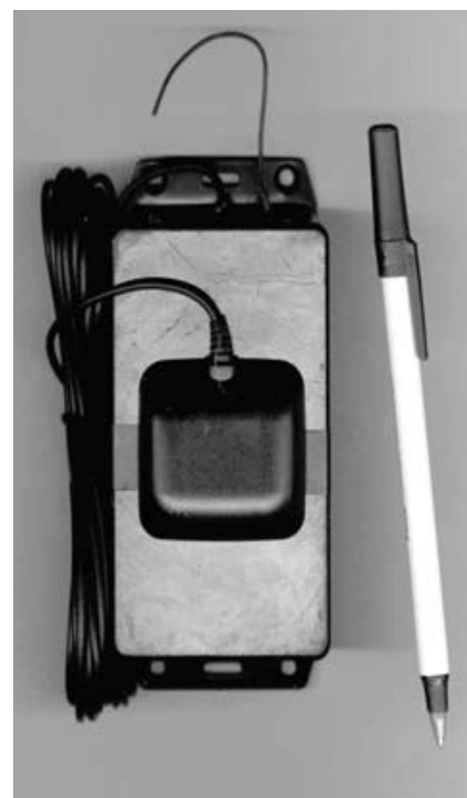
GPS-передатчик. Несмотря на малые размеры, его не так просто укрыть от глаз угонщика – мощность сигнала не позволяет установить его в глухом закутке автомобиля.
