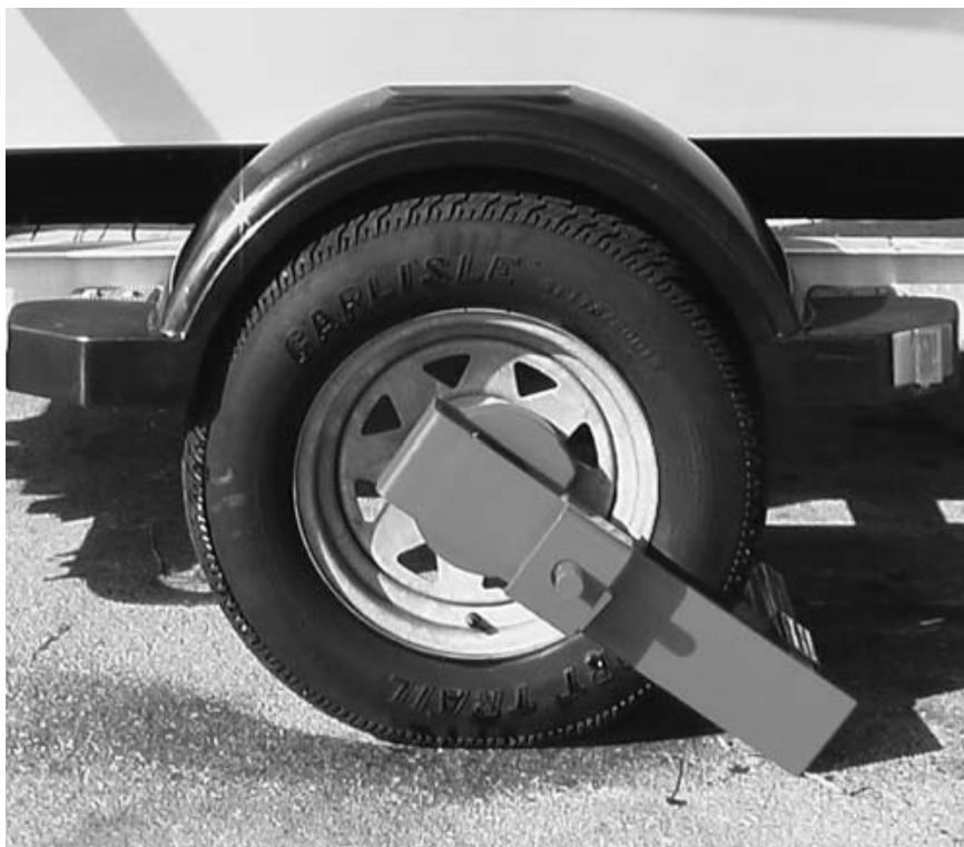
Механические иммобилайзеры колес достаточно надежны, но не пользуются большой популярностью: кому охота пачкаться, устанавливая каждый раз эту громоздкую штуку?
