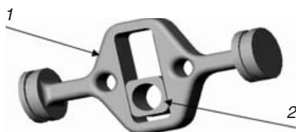
Рис. 1. Поршни гармонического двигателя с оппозитным коаксиальным расположением цилиндров соединены кросс-штоком в одну цельную деталь (1), в прорези которой перемещается ползун (2), охватывающий шейку коленвала (упрощенно).
