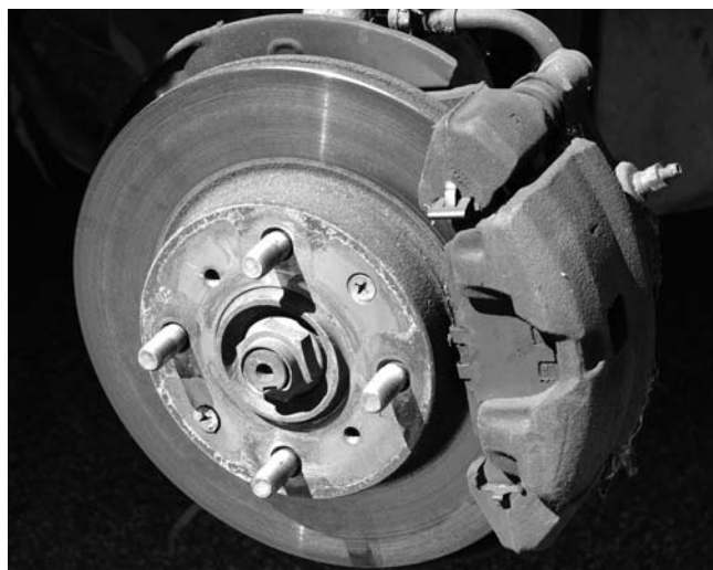
Дисковые тормоза лучше охлаждаются, потому что воздух может свободно циркулировать между диском и поверхностью колодки.
