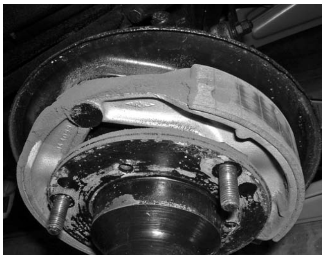
Барабанные тормоза на задней оси собирают больше пыли от колодок, но меньше грязи с дороги, поэтому медленнее изнашиваются.
