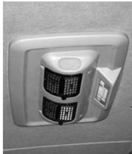
На случай, если снаружи станет слишком холодно, дефлектор оборудован жалюзи, полностью прерывающими любой контакт с внешним воздухом.
