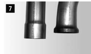
7 Новая заменная труба длиннее, чем старая срезанная труба.
