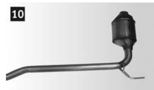
12 Новая заменная труба на «старом» действующем катализаторе.
