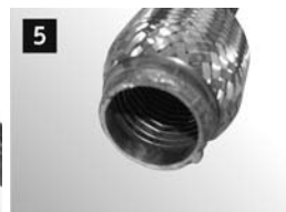
17 Когда отверстие очищено (все остатки старой трубы должны быть удалены), можно вставлять новую заменную трубу.
