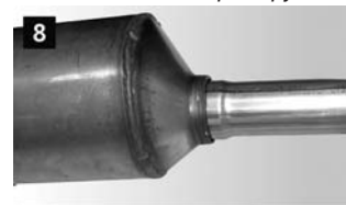
8 Заменную трубу ввести в конус катализатора на глубину около 10 – 15 мм.
