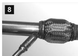
18 Новую трубу вставить на глубину примерно 10 мм в гофру и приварить.
