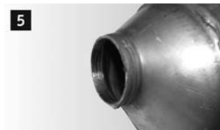
5 Когда отверстие очищено (все остатки старой трубы должны быть удалены), можно вставлять новую заменную трубу.
