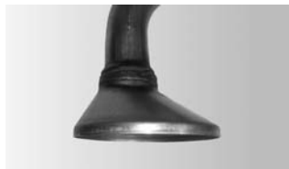
10 Приварить новую заменную трубу.
