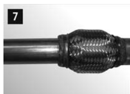
18 Новую трубу вставить на глубину примерно 10 мм в гофру и приварить.
