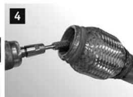
16 Сварной шов отфрезеровать механическим абразивным инструментом до полного очищения от остатков старой трубы.
