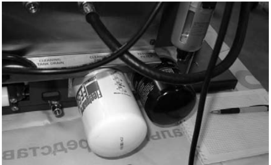
К вопросу о расходных материалах: прибор использует обычные топливные фильтры.
