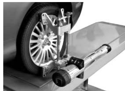
В компактном магниевом корпусе поды спрятаны видеокамера, чувствительная микросхема, ИК-датчик, устройство радиосвязи стандарта Bluetooth и аккумулятор.
