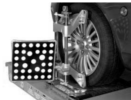
Легкие и «неубиваемые» оптические мишени монтируются на передние колеса с помощью держателей
