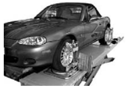
Размещение видеокамеры на колесе автомобиля снимает все ограничения, связанные с обеспечением видимости мишеней.
