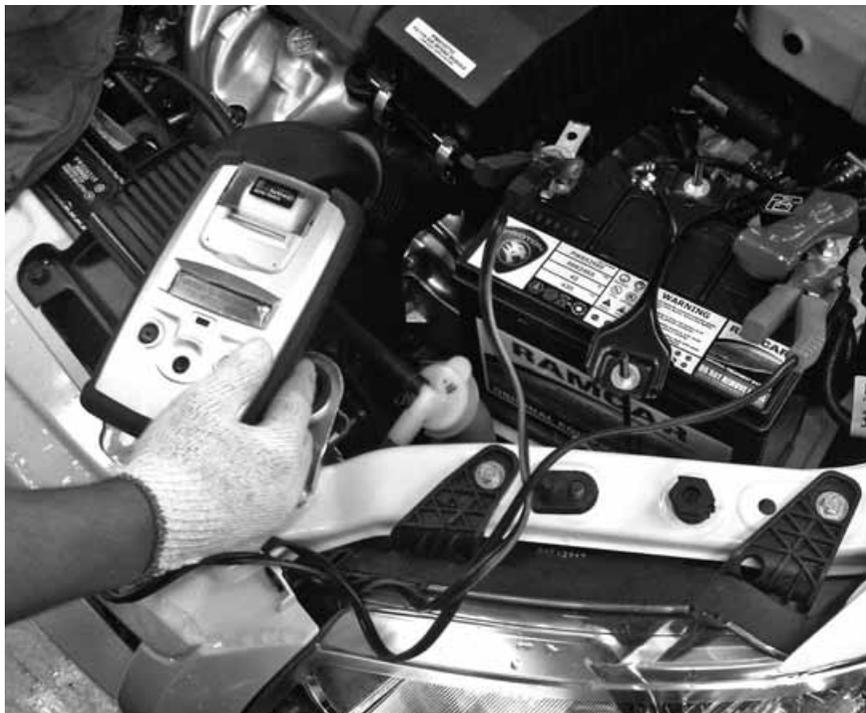
Название «необслуживаемый» не отменяет ряда контрольных операций в отношении любого аккумулятора: проверка крепежа; затяжка наконечников на клеммах, своевременная их очистка от окислов; очистка корпуса от грязи; проверка вентиляционных каналов для удаления газа, образующегося в процессе работы автомобильного аккумулятора.
