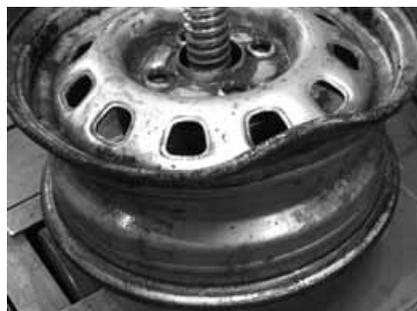
ограничивает ресурс пластичности обода колеса в пределах 10-15%. Максимальное утонение в местах радиусных переходов от боковой стенки к середине центрального ручья составляет 20% от толщины исходного металлопроката согласно ОСТ 37.001.246-82. Это свидетельствует об отсутствии резервов пластичности металла для дальнейшего пластического формоизменения. Места правки будут обладать пониженной прочностью и жесткостью.
