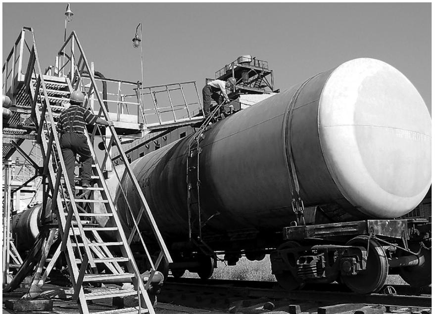
*Работники предприятия сливают из железнодорожных цистерн компоненты базовых масел, которые затем перекачиваются в цеха с помощью специальной системы трубопроводов.*
