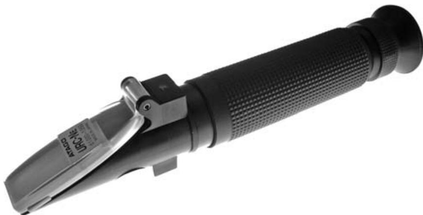
*Рефрактометр. Фактически этот прибор измеряет оптическую характеристику антифриза - показатель преломления, который тоже связан со степенью разведения концентрата антифриза водой и его температурой начала кристаллизации.*
