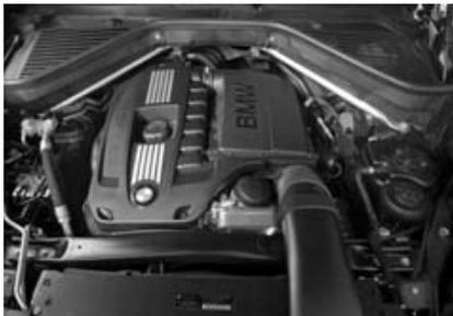
Версию BMW XDrive35i баварские мотористы оборудовали 6-цилиндровым двигателем N55. Этот мотор во многом идентичен прежнему, но более тяговит (до 306 л.с. мощности и 400 Нм максимального крутящего момента) и расходует меньше топлива. Двигатель сочетается с 8-ступенчатой автоматической КПП ZF. Такой же «коробкой» агрегируется 4,4-литровый 407-сильный мотор V8, который устанавливается на версию XDrive50i.
