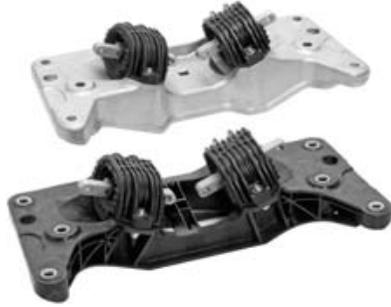
Новая пластиковая поперечина трансмиссии идеально «вписывается» в то пространство, которое предусмотрено для нее конструкцией автомобиля. Кроме того, она в полной мере удовлетворяет требованиям по термостойкости, обусловленным близостью ее расположения к выхлопной системе двигателя, и в большей степени является пригодной для переработки.
