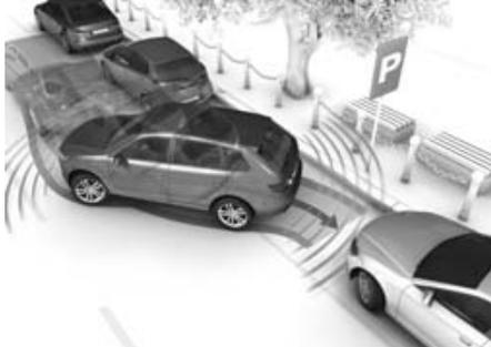
ля позволяют парк-пилоту обнаруживать любые препятствия на расстоянии до 1,5 м, включая такие небольшие объекты, как низкие цветочные клумбы. Новая система также подходит для автомобилей с фаркопом. Сверхкомпактные корпуса датчиков, окрашиваемые под цвет автомобиля, легко устанавливаются в передние или задние бамперы. Парк-пилот Bosch URF7 поставляется в передней и задней модификациях. Установить систему помогут готовые монтажные наборы и подробные инструкции.
