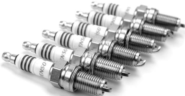
Toyota Avensis с двигателями 1,6, 1,8 и 2,0 литра, Toyota IQ с литровым двигателем и 1,3 литра, Toyota Urban Cruiser 1,3 и Toyota Prius 1,8 литра комплектуются на конвейере свечами зажигания Denso Iridium Longlife с центральным иридиевым электродом диаметром 0,7 мм, платиновой напайкой на боковом электроде. По словам производителя комплектующих срок службы данных свечей – до 100 тыс. км.
