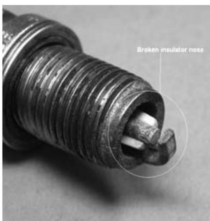
Треснувший керамический наконечник изолятора свидетельствует о том, что свеча крайне сильно перетянута. В данном случае изолятор отделяется от металлического корпуса и вибрирует, вызывая повреждения.
