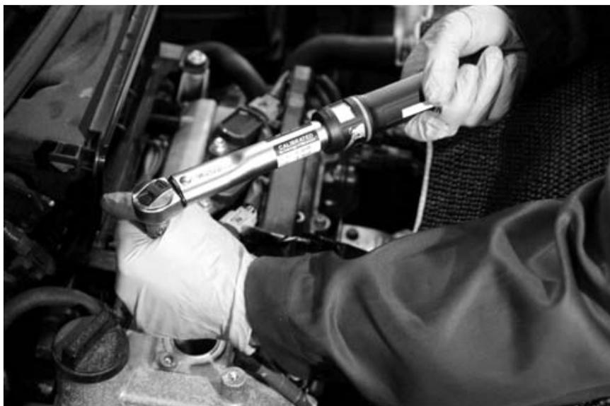
Момент затяжки в действии. Большинство проблем и возвратов свечей зажигания возникает по причине слишком большого момента затяжки.
