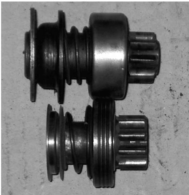
Фото 12. В погоне за удешевлением стартера некоторые производители уменьшают размер обгонной муфты, что значительно сокращает срок его службы.
