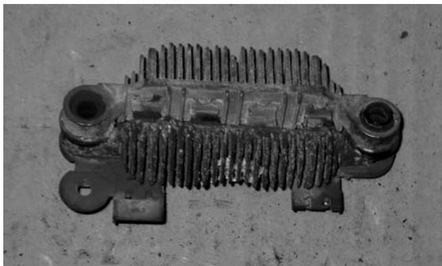
Фото 14. Это - "утопленник", т. е. диодный мост генератора от автомобиля, транспортировавшимся в Украину морем, и в целях экономии места свисавший над бортом корабля. Соленые морские волны сделали свое дело.
