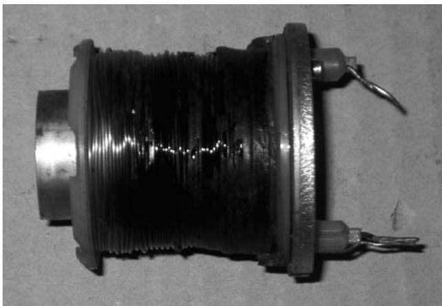
Фото 6. Сгоревшая обмотка втягивающего реле (соленоида) неопровержимо свидетельствует о том, что стартер слишком долго (более 3 минут) эксплуатировался без остановки. Такие случаи по гарантии не принимаются.
