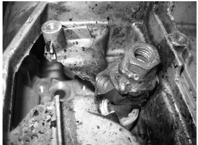
Фото 20. Попытка демонтажа форсунки без соответствующих инструментов. К форсунке приварили гайку, по ней били молотком и при этом сломали клапанную крышку. В итоге в негодность пришла головка блока цилиндров, но форсунку так и не сняли.
