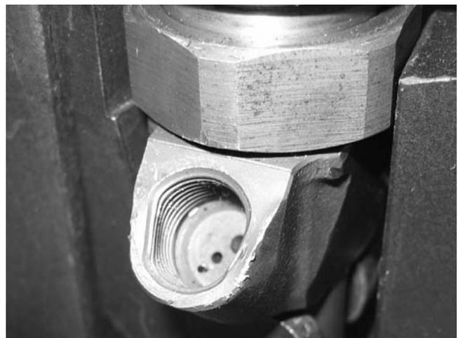
Фото 21. Еще один пример неудачной попытки снять форсунку.
