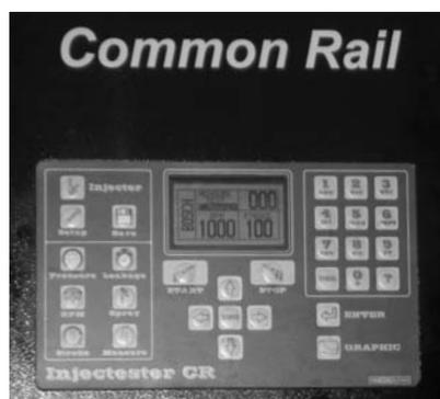
Фото 7. Панель управления стенда InjecTester Common Rail
