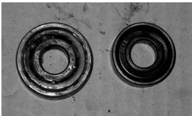
Фото 9. Подшипники с металлической ободкой на генератор ставить не стоит из-за "неудержания" смазки при нагреве даже до рабочей температуры подкапотного пространства (около 80 градусов).
