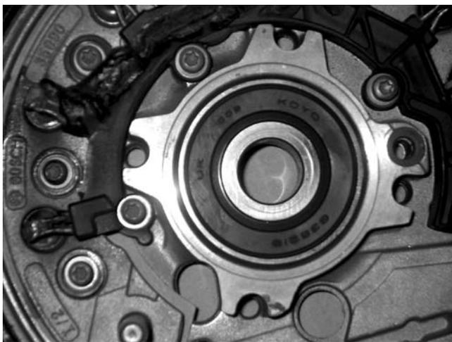
Фото 4. 150-амперный генератор буквально расплавился из-за неисправностей в аккумуляторе.
