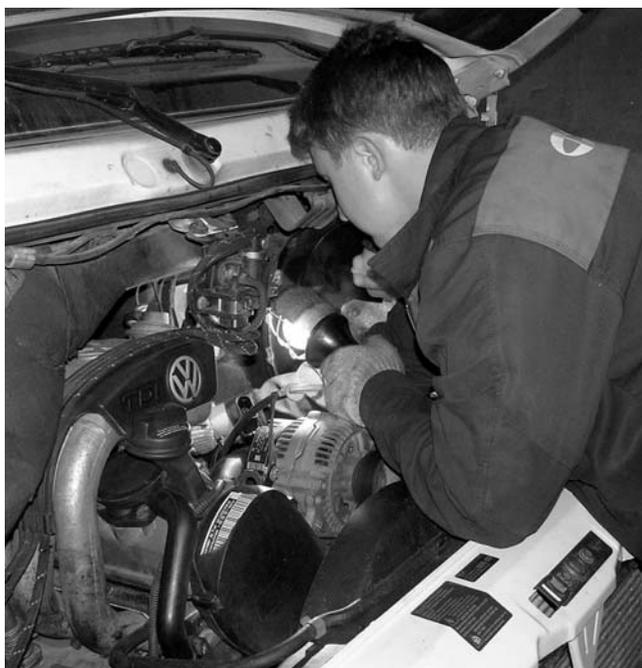
Фото 2. Предварительный осмотр дизельной топливной аппаратуры на автомобиле.
