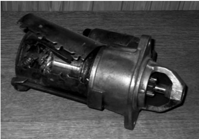
Фото 1. Этот стартер вышел из строя, потому что на нем не убиралась команда "пуск". Стартер буквально разорван центробежной силой.
