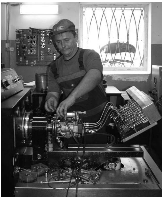
Фото 5. Тестирование ТНВД электронным регулятором на стенде.
