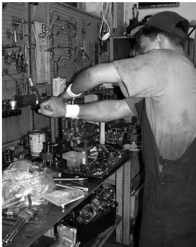
Фото 6. Идет ремонт одноплунжерного ТНВД VE-типа.
