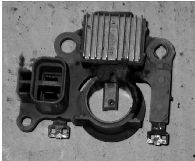
Фото 13. Этот реле-регулятор сгорел вследствие попадания на него масла.
