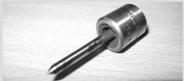
Фото 11. Распылитель, носик которого отвалился и попал в двигатель.
