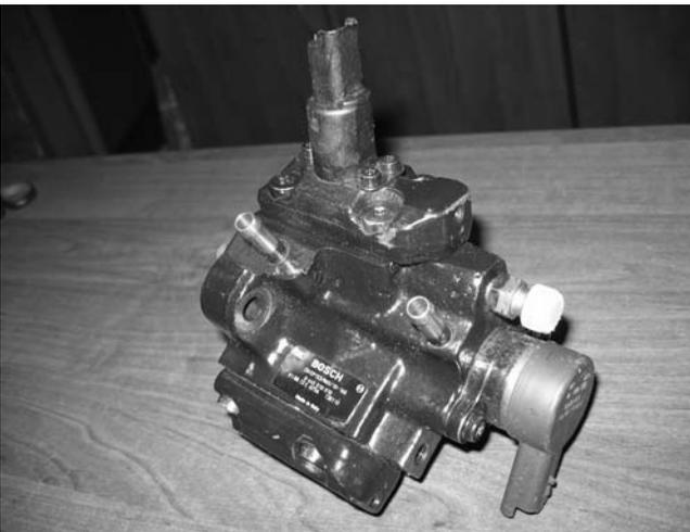
Фото 29. Common Rail насос фирмы Bosch системы CP-1 стандарт.
