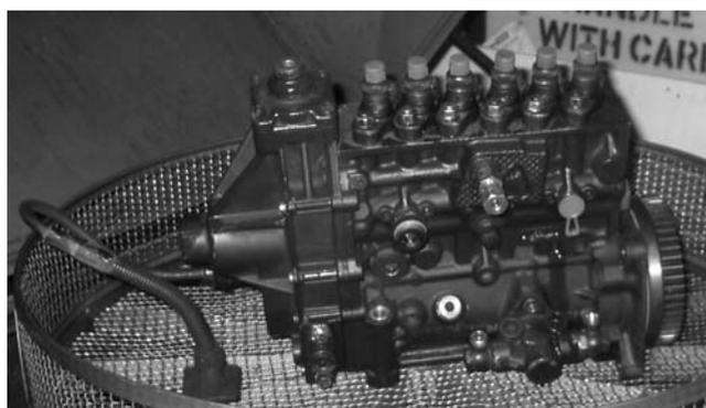
Фото 15. Классический ТНВД. После мойки он устанавливается на стенд и проверяется на соответствие тестовым параметрам. К сожалению, почти никто не проводит плановых проверок, а на СТО приезжают, когда уже ничего ничему, так сказать, не соответствует. Затем - разборка и дефектовка, заказ-наряд согласовывается с заказчиком, предлагается ассортимент оригинальных и альтернативных запчастей.
