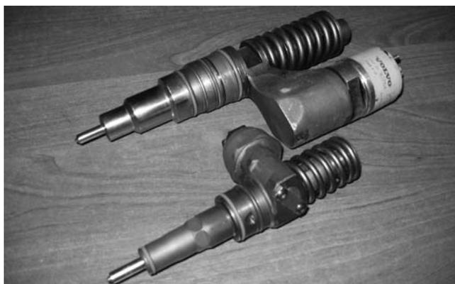
Фото 27. Насос-форсунки (большая - Volvo FH-12, вторая устанавливается на Audi, Fiat, Skoda).
