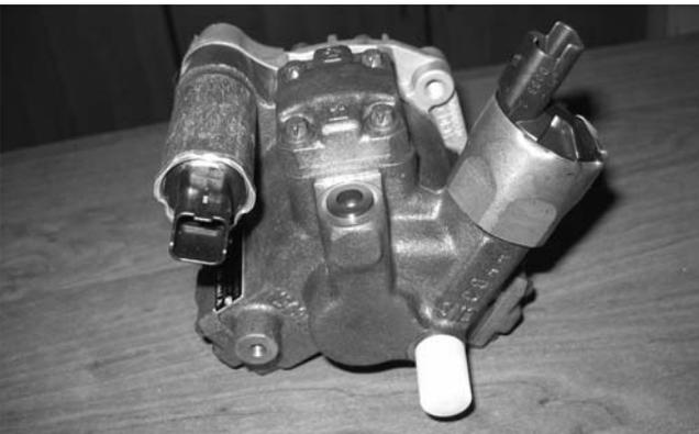
Фото 30. Common Rail насос фирмы Siemens.
