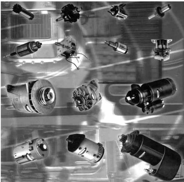
Различные типы генераторов и их детали.
