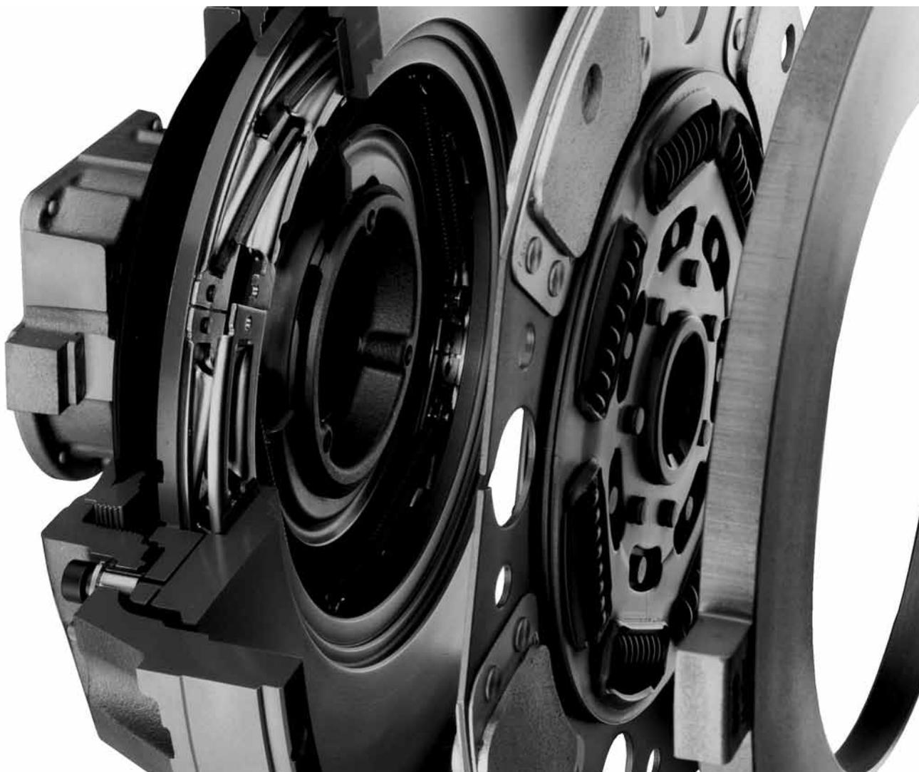
*«Корзина» – это упрощенное название сборочной единицы, включающей в себя нажимной диск, кожух сцепления и нажимную пружину.*
