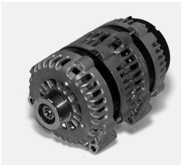
*Первый источник электричества в автомобиле – это установленный на двигателе генератор, преобразующий механическую энергию в электрическую и снабжающий ею при работающем двигателе всех потребителей, а равно и подзаряжающий АКБ.*
