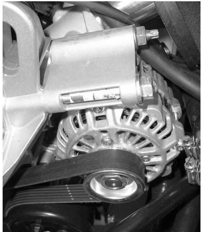
Механическую энергию, необходимую для получения электрической, генератор получает от шкива на коленчатом валу двигателя через ременную передачу.
