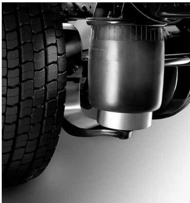
*Пневматическая подвеска позволяет добиться высокой плавности хода.*
