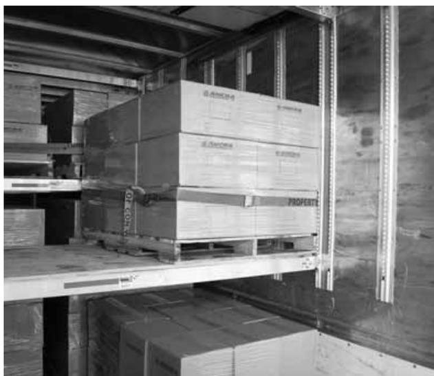
Каждая поперечина выдерживает вес около тонны, в зависимости от производителя.
