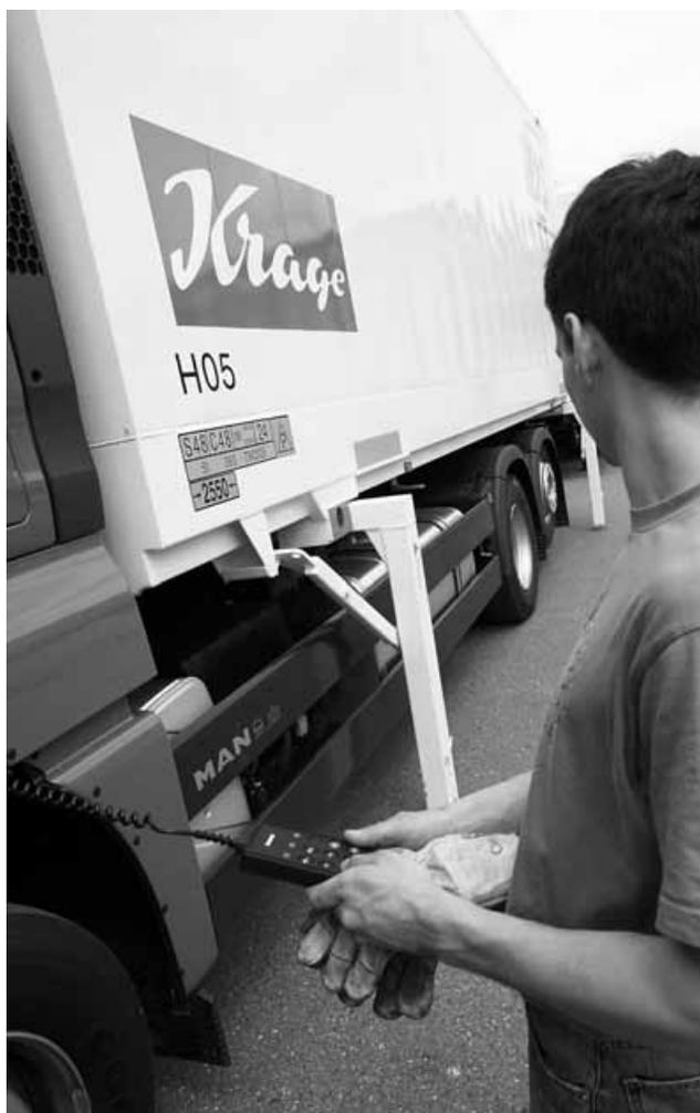
*Дистанционный пульт позволяет очень удобно управлять подвеской в ручном режиме (например, при погрузке/разгрузке у рампы).*
