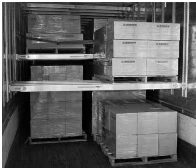
Использование системы двухъярусной погрузки позволяет эффективно разместить груз в полуприцепе.
