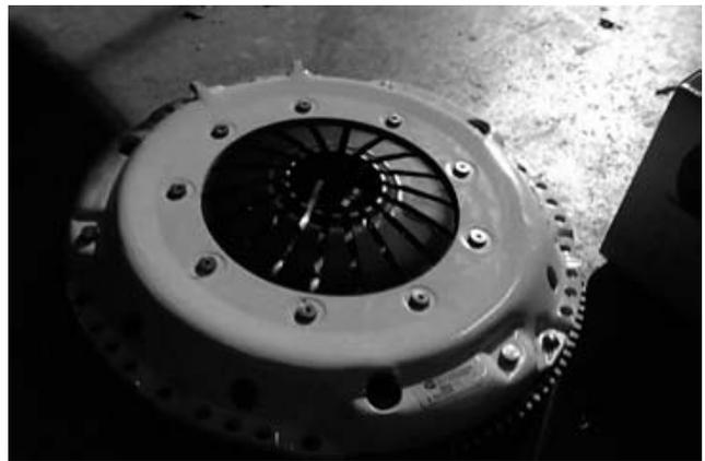
го неисправность возникает из-за неполадок с системой выключения сцепления или отсутствия вращения подшипника коленчатого вала. Несоблюдение технологических требований при сборке сцепления также может стать причиной неисправности.
