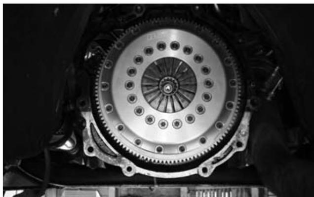
вследствие неправильного переключения, неквалифицированной буксировки или неправильного обслуживания на роликовом испытательном стенде. Зазор в трансмиссии. Искривление в ходе сборки и установки.
