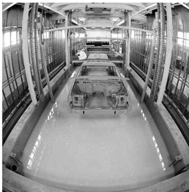
*Катафорезные грунтовки изготавливают на основе акриловых и винильных сополимеров, эпоксидных, полиуретановых, полиэфирных и других смол с амино- или аммониевыми группами, которые путем нейтрализации кислотами переводят в солевую водорастворимую форму и затем разбавляют водой до получения 20-25%-го раствора.*
