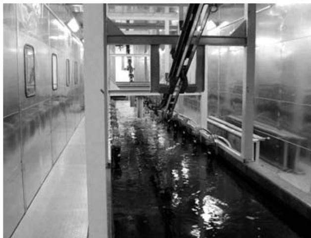
*Катафорезные ванны, промывочные камеры и трубопроводы должны быть выполнены из материала, не корродирующего в кислой среде. Таким материалом служит, как правило, нержавеющая сталь, а в некоторых случаях - полиэфирные футеровочные материалы.*
