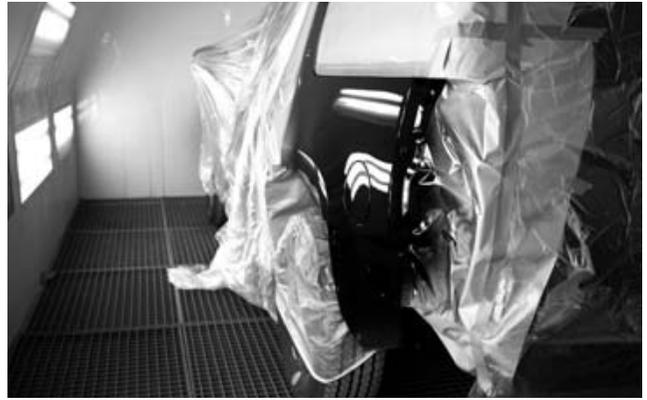
*Вместо бумаги можно использовать пластиковые пленки из полиэтилена. Они обладают значительными преимуществами по сравнению с бумагой: не имеют ворса и не несут статический электрический заряд, который притягивает к пленке пыль, содержащуюся в окружающем воздухе помещения, а также в сжатом воздухе, поступающем из краскопульты.*
