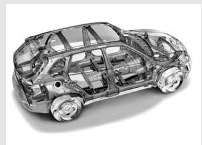
*«Пятерка» (и «семерка») BMW построены с активным применением алюминиевых. Подобное решение позволяет снизить общий вес автомобиля и, одновременно с этим, добиться более равномерной развесовки по осям.*
