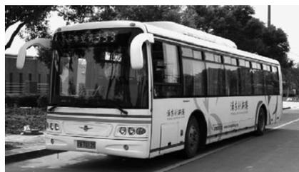
Ultracap Hybrid Bus может проехать без подзарядки 72 км, при включенном на полную мощность кондиционере. Номинальная вместимость у этой модели такая же, как и у чисто конденсаторного собрата, – 41 человек, а максимальная скорость повыше – 53 км/ч.
