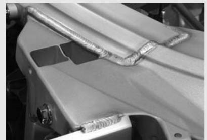
*Результатом почти 20-летних исследований и опытно-конструкторских работ Audi стал выпуск пространственной рамы ASF – высокопрочной алюминиевой структуры, в которую встроены большие алюминиевые панели, принимающие на себя часть нагрузки.*
