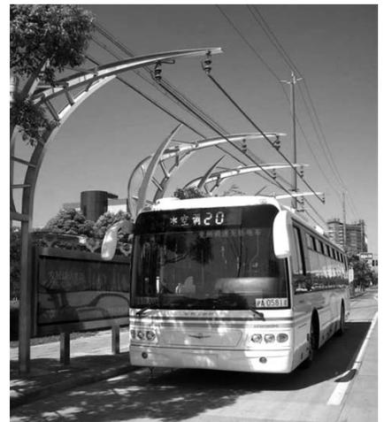
*41-местный китайско-американский Ultracap Bus весит 11,3 тонны (сравнимо с массой обычных автобусов и троллейбусов одиночек), из которых на суперконденсаторы приходится 980 кг. В длину автобус насчитывает 11,4 метра. Максимальная же скорость Ultracap Bus составляет 48 км/ч.*
